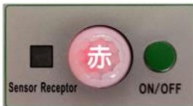
ソーラーパネルに光を当てると明るさを感知して、LED ライトは消灯して、本体の充電を開始します。インジケータランプ赤になります。
